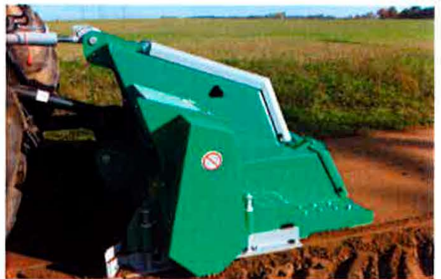
Schotterfräse HEN-WPF 200 beim Fräsen-Mischen-Profilieren-Rückverfestigen
